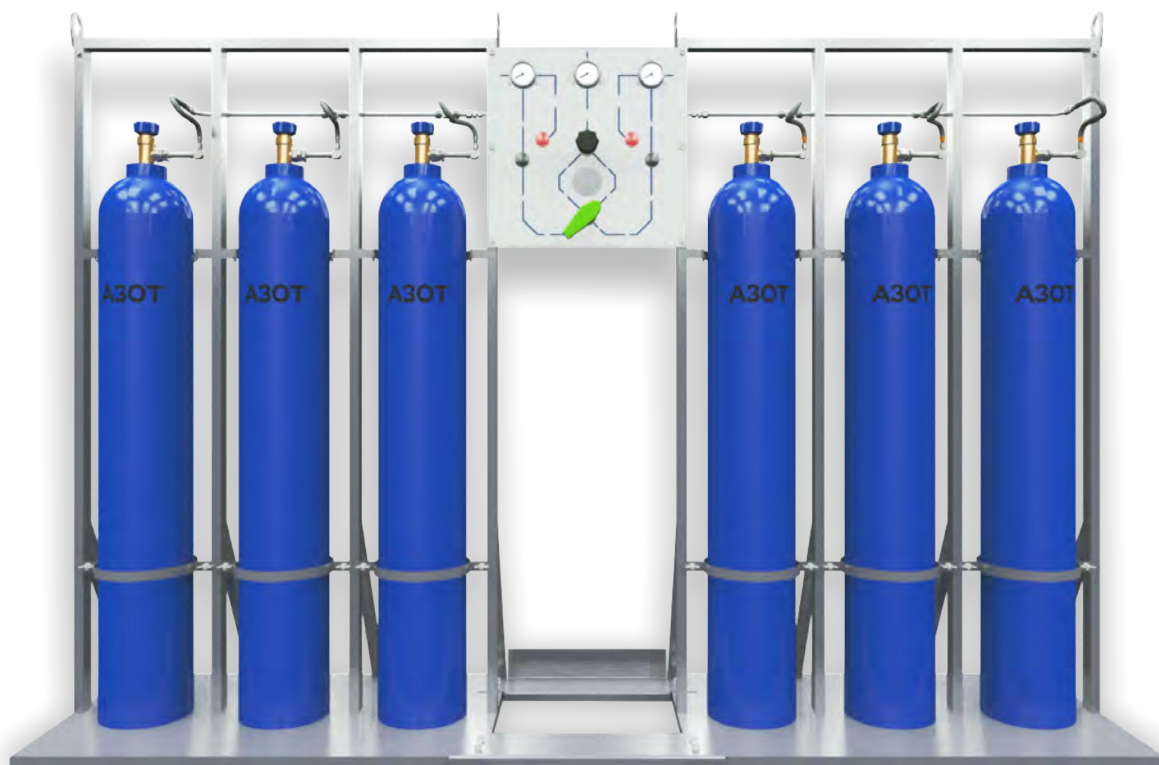
Система непрерывной подачи газа в панельном исполнении с автоматическим переключением (СНПГ-40) с выбором основной или резервной группы баллонов
